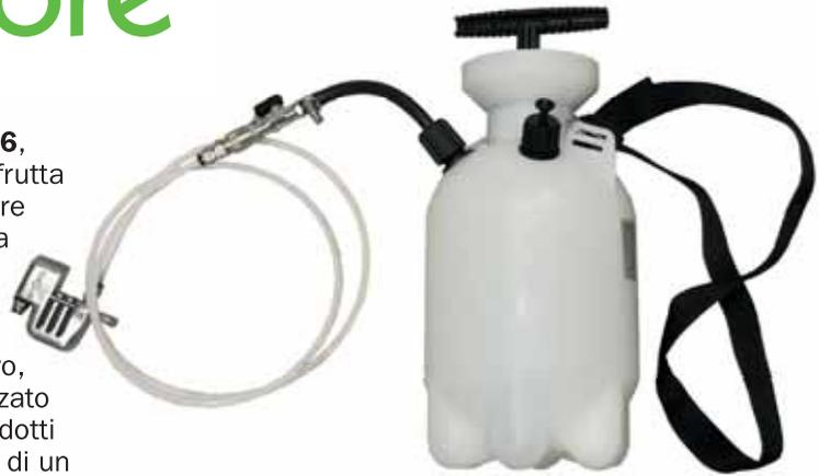
**Atom6** è collegato alla pompa a precompressione attraverso un tubo in poliammide ed è fissato all'estremità del tubo del soffiatore. Il liquido, una volta messo in pressione all'interno della pompa, scorre lungo il tubo fino al corpo di **Atom6** e viene nebulizzato attraverso l'**ugello**. Il flusso d'aria del soffiatore, investendo il getto nebulizzato, spinge con forza le particelle di liquido, rompendole ulteriormente e creando un **flusso atomizzato**.
