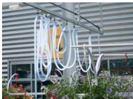
■ Una soluzione singolare per trasportare il tubo per l'irrigazione nella serra, senza abbandonarlo a terra con il rischio di far inciampare i clienti.
